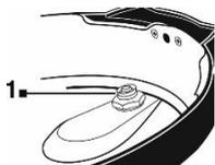
Odstráňte malé tesnenie zo spodnej časti horného veka, stiahnite modrý bezpečnostný ventil z hornej časti a umyte ho v teplej mydlovej vode. **Pravidelne kontrolujte uvoľňovaciu maticu na odvzdušňovacej rúrke ventilu na uvoľnenie tlaku. V prípade potreby ju jemne dotiahnite kľúčom.**
