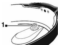
Îndepărtați garnitura mică din partea inferioară a capacului superior, scoateți supapa de siguranță albastră din partea superioară și spălați-o în apă caldă cu săpun.
