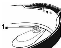
Z modrého bezpečnostního ventilu sejměte malé těsnění ze spodní strany horního víka, vytáhněte modrý bezpečnostní ventil na horní straně a umyjte jej v teplé, mýdlové vodě. **Pravidelně kontrolujte uvolňovací matici odvzdušňovací trubky ventilu pro uvolnění tlaku.**
