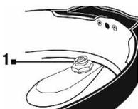
Entfernen Sie die kleine Dichtung des blauen Sicherheitsventils an der Unterseite der oberen Abdeckung, ziehen Sie das blaue Sicherheitsventil an der Oberseite heraus und waschen Sie es in warmem Seifenwasser. **Überprüfen Sie regelmäßig die Entriegelungsmutter am Entlüftungsrohr des Ventils auf Druckentlastung. Falls erforderlich, ziehen Sie sie mit einem Schraubenschlüssel vorsichtig nach.**
